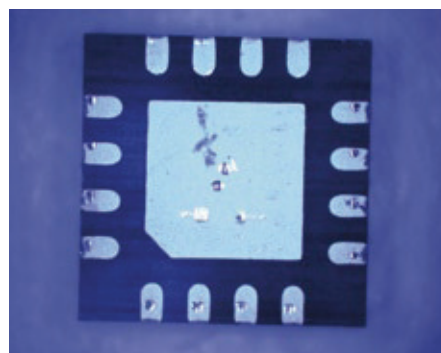
Gehäuse einer integrierten Schaltung (2D)
